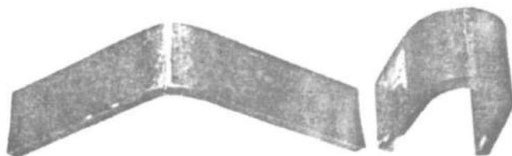
شکل ۸ - ۱۷ نمونه آزمایش خمش ریشه. نمونه سمت راست به‌طور رضایت‌بخشی در آزمایش مقاومت کرده در حالی که نمونه سمت چپ قبل از خمش کامل ترک خورده و شکسته شده است. به‌نفوذ کامل جوش در نمونه مورد قبول توجه کنید.
