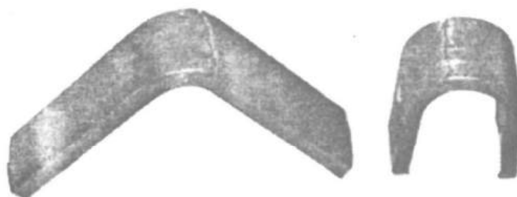
شکل ۸ - ۱۶ نمونه‌های آزمایش خمش رویه. نمونه سمت راست به‌طور رضایت‌بخشی در آزمایش مقاومت کرد در حالی که نمونه سمت چپ قبل از خمش کامل ترک خورد و شکست.
