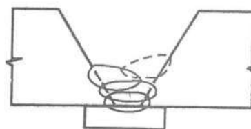
(ب) عرض ریشه برای پاس بعدی در حد فاصل لبه ورق و نوار جوش وجود ندارد و احتمال ذوب ناکافی موجود می‌باشد
