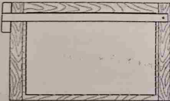
الف) قرار دادن خط کش تی و کاغذ روی تخته
